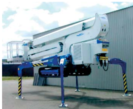
Fig. 58 Liften løftet ved hjælp af støttebenene
