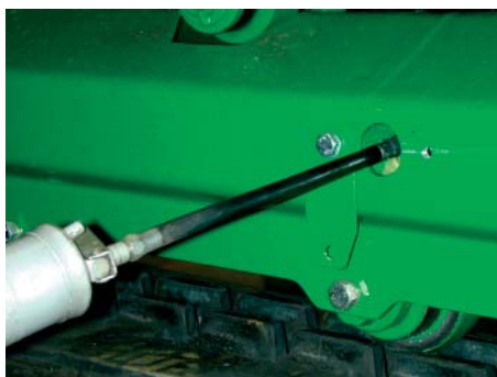
Fig. 67 Smørepistol for smørenippel på strammerullen.
