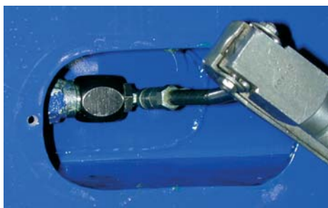
Fig. 67a Smørepistol på smøreニפל med adapter for strammerullen.
