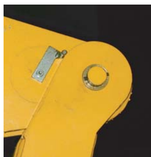
Sikkerhedshåndtag – Åbent: Ustabil!
